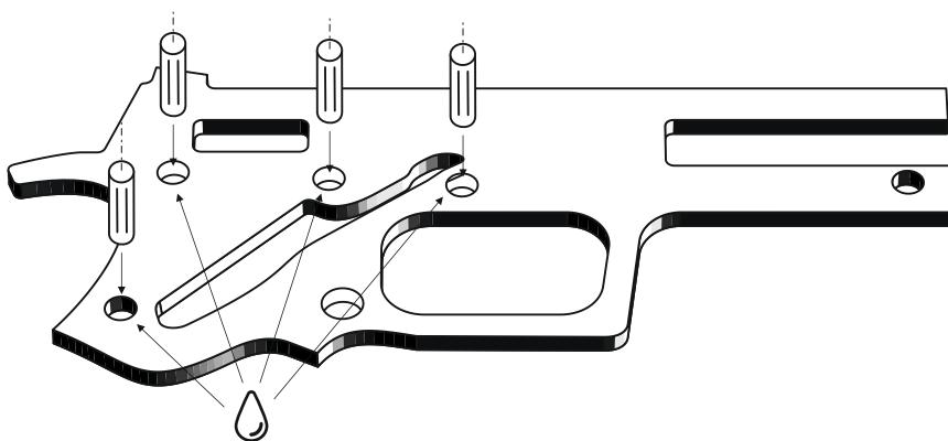
! При склеивании деталей следите, чтобы **клей** не попал на шкант.
