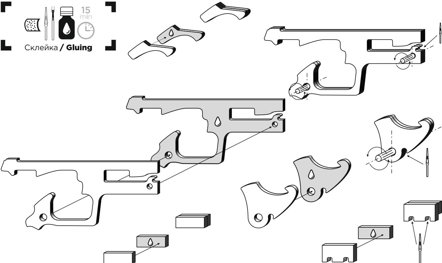
! При склеивании деталей следите, чтобы **клей** не попал на шкант.
